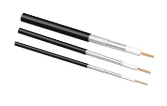
同轴射频电缆是较常用的结构型式。由于其内外导体处于同心位置,电磁能量局限在内外导体之间的介质内传播,因此具有衰减小,屏蔽性能高,使用频带宽及性能稳定等优点。通常用来传输500千赫到18千兆赫的射频能量。目前,常用的射频同轴电缆有两类: 50Ω和75Ω的射频同轴电缆。特性阻抗75Ω射频同轴电缆常用于CATV网,故称为CATV电缆,传输带宽可达1GHz□目前常用CATV电缆的传输带宽为750MHz□对称射频电缆回路其电磁场是开放型的,由于在高频下有辐射电磁能,因而使衰减增大,并导致屏蔽性能差,再加上大气条件的影响,通常较少采用。对称射频电缆主要用在低射频或对称馈电的情况中。轴或对称电缆中的导体,有时可做成螺旋线圈状,借以增大电缆的电感,从而增大了电缆的波阻抗及延迟电磁能的传输时间,前者称为高阻电缆,后者称为延迟电缆。如果螺旋线圈沿长度方向卷绕的密度不同,则可制成变阻电缆。射频电缆组件主用于航空航天连接器和代通信系统中□LMR系列电缆生产
